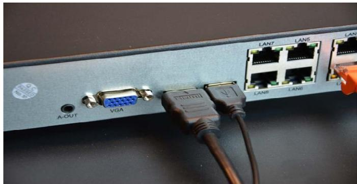
fornire una risoluzione bassa (1280x1024) in modo da essere compatibili con tutti i monitor. Una volta collegato il monitor e avviato il XVR/NVR ti conviene aumentare la risoluzione dell'uscita video fino alla massima supportata del tuo monitor (di regola FullHD 1920x1080 o 4K 3840x2160).
