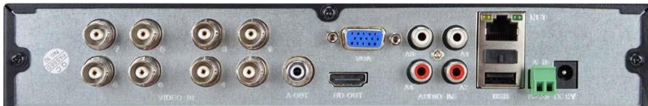
**VIDEO IN** Ingressi video di tipo BNC, per collegare qualsiasi tipo di telecamera analogica in tecnologia AHD, CVI, TVI o analogiche CVBS.
