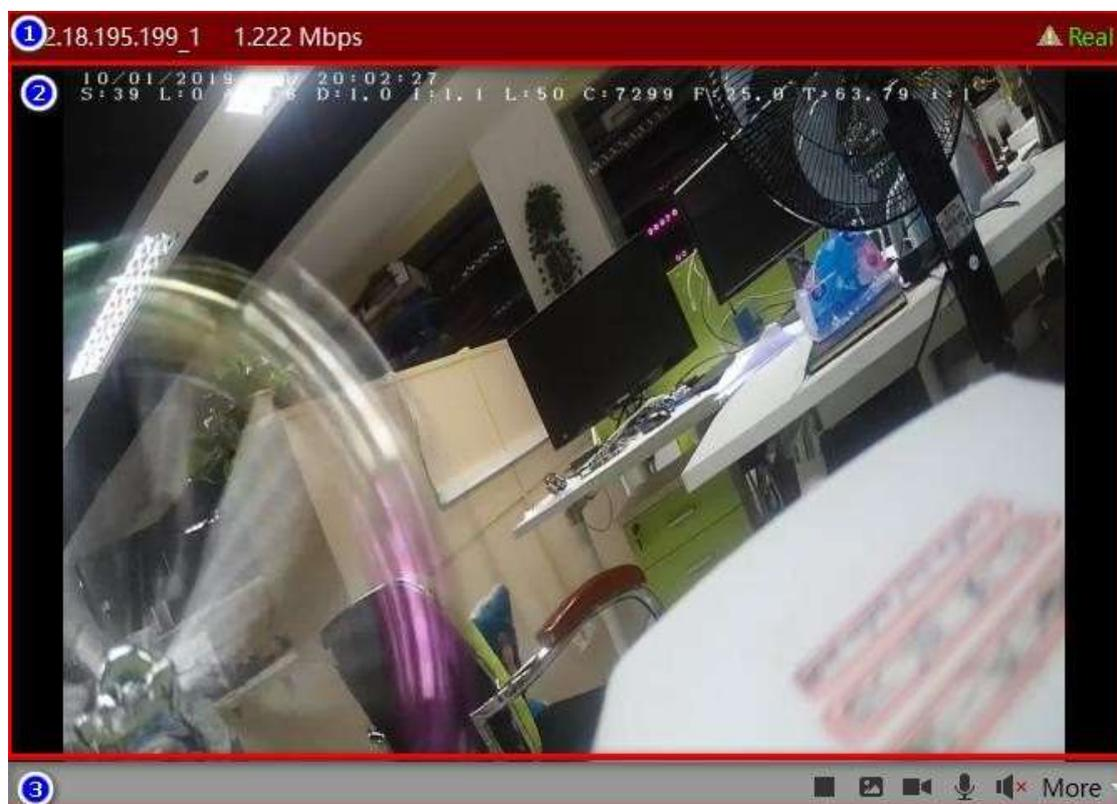
① Barra del titolo della finestra di riproduzione: mostra il nome del canale del dispositivo, il valore degli Mbps e lo stato dell'immagine del dispositivo. Il punto esclamativo sul Triangolo indica che il dispositivo ha rilevato un oggetto movimento sullo schermo.
